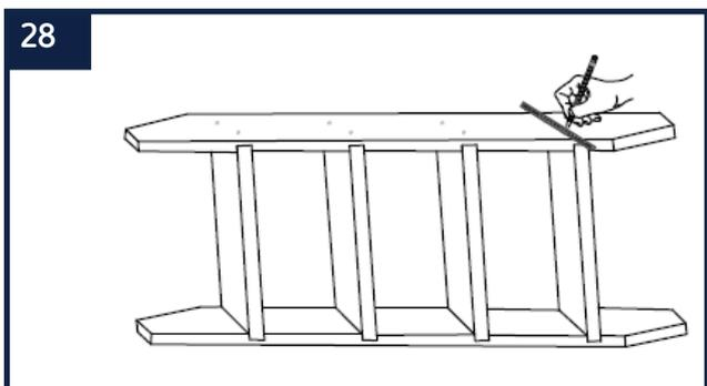
Utilisez une règle et un crayon de papier pour indiquer l'emplacement des trous qui permettront de fixer les marches.
