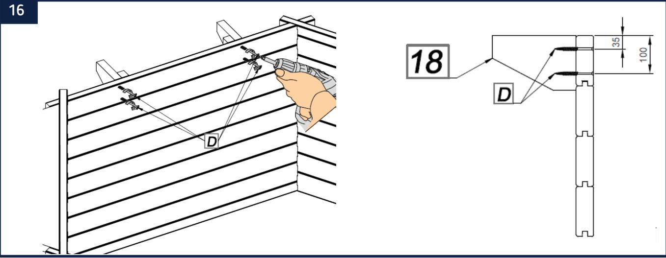
Fixez à l'extérieur de votre piscine, 12 supports de margelle (18) aux endroits mentionnés sur le schéma page 23. Pour cela, fixez chaque support à l'aide de 2 vis 5 x 100 mm (D) en suivant avec attention les côtes indiquées sur le schéma ci-dessus. Pour vous faciliter la tâche, utilisez une visseuse équipée d'un embout PZ2.
