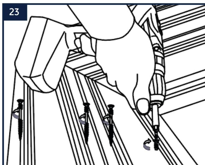
Fixez les margelles à l'aide des vis 5 x 60 mm (H) en commençant par les margelles intérieures. Celles-ci sont fixées sur l'ossature bois et sur le croisement des parois de la piscine. Fixez ensuite les margelles extérieures sur les supports de margelles ou sur les renforts horizontaux lorsqu'il s'agit de grandes longueurs ou de la paroi de l'escalier.
