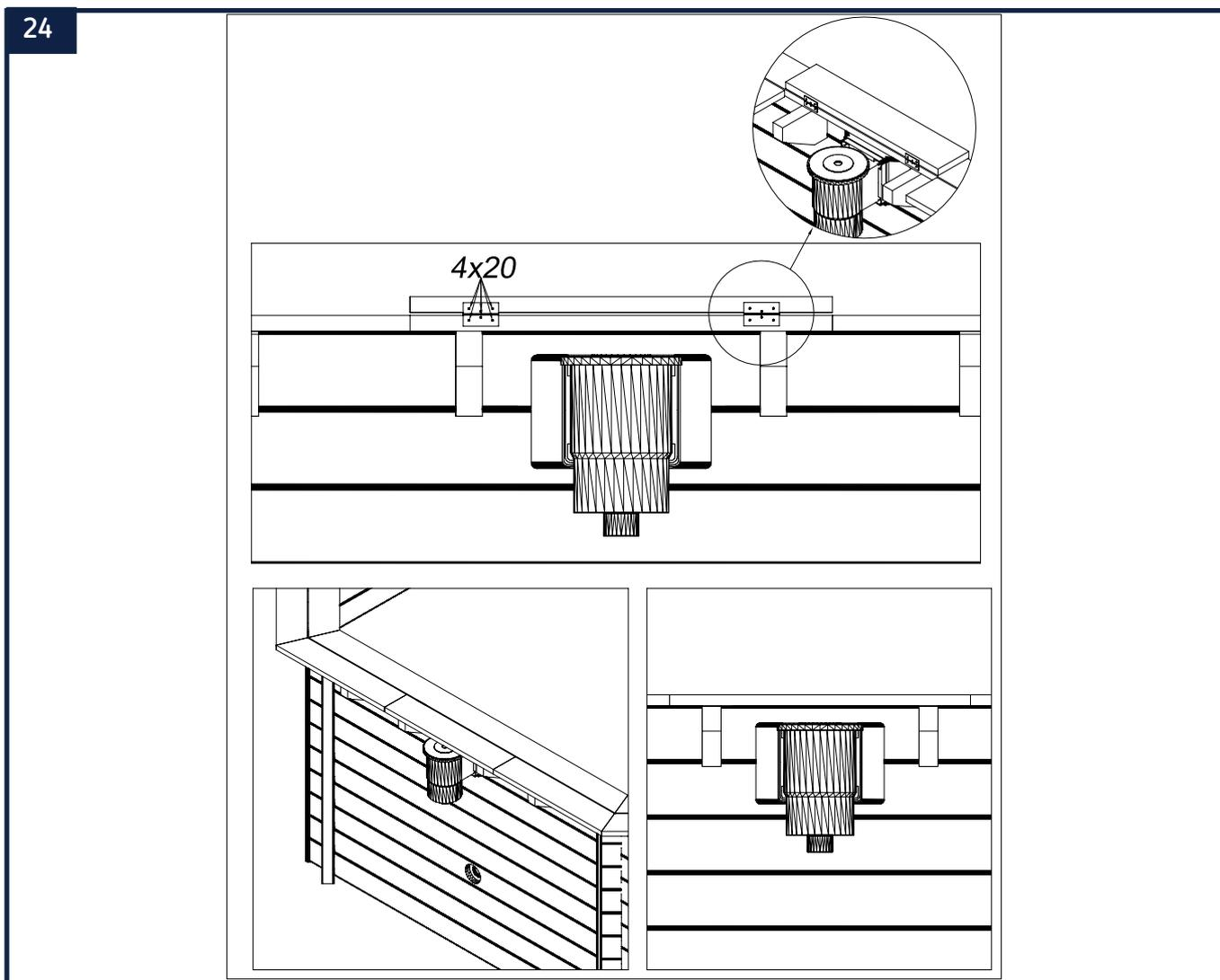
Fixez, à l'aide des vis 4 x 20 mm (C), les charnières (A) sur la tranche de la margelle amovible (10) et la tranche de la margelle intérieure (9) positionnée au niveau du skimmer comme indiqué sur le schéma ci-dessus.
