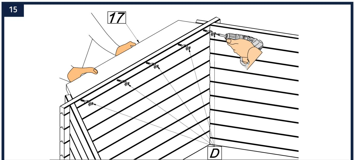
Le renfort d'escalier (17) doit ensuite être fixé à l'extérieur du bassin à l'aide de 5 vis 5 x 100 mm (D). Pour vous faciliter la tâche, utilisez une visseuse équipée d'un embout PZ2.
