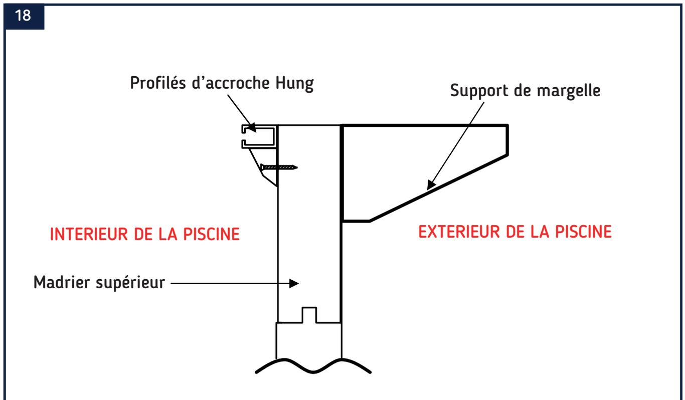
Les profilés de PVC blanc Hung seront fixés en haut de la paroi, à l'intérieur du bassin, à l'aide des vis 3 x 35 mm (E). Coupez les profilés à la mesure des côtés intérieurs de la piscine à l'aide d'une scie à métaux. Gardez les chutes : elles vous serviront à terminer le dernier côté. Les vis doivent être espacées de 20 à 25 cm. Attention, le haut du profilé en PVC doit être positionné à la limite supérieure de l'ossature (voir schéma ci-dessus).
