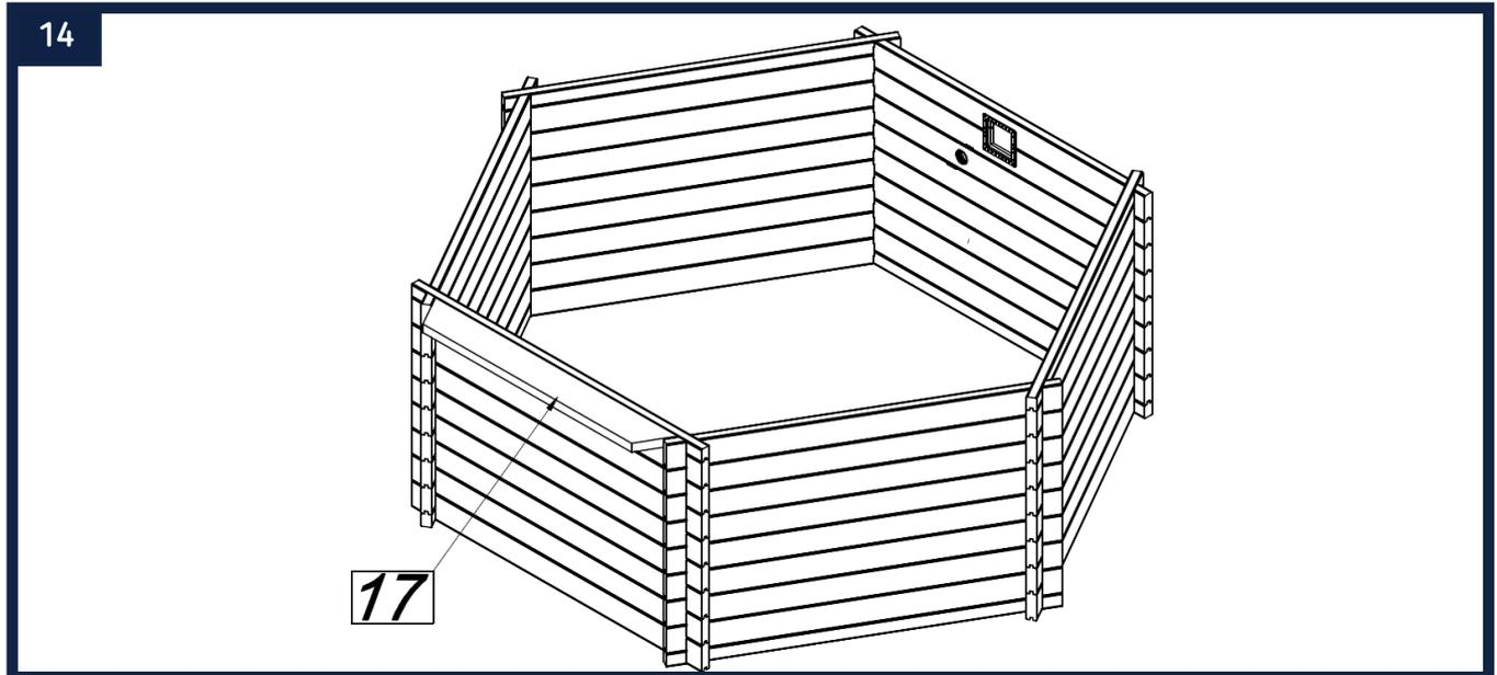
Identifiez le positionnement du renfort d'escalier (17) en vous référant au schéma ci-dessus. Celui-ci doit être positionné à l'opposé du skimmer.
