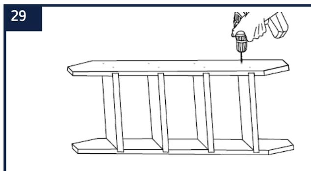
Une fois les trous indiqués, percez-les à l'aide d'une perceuse équipé d'un foret de 3 mm.
