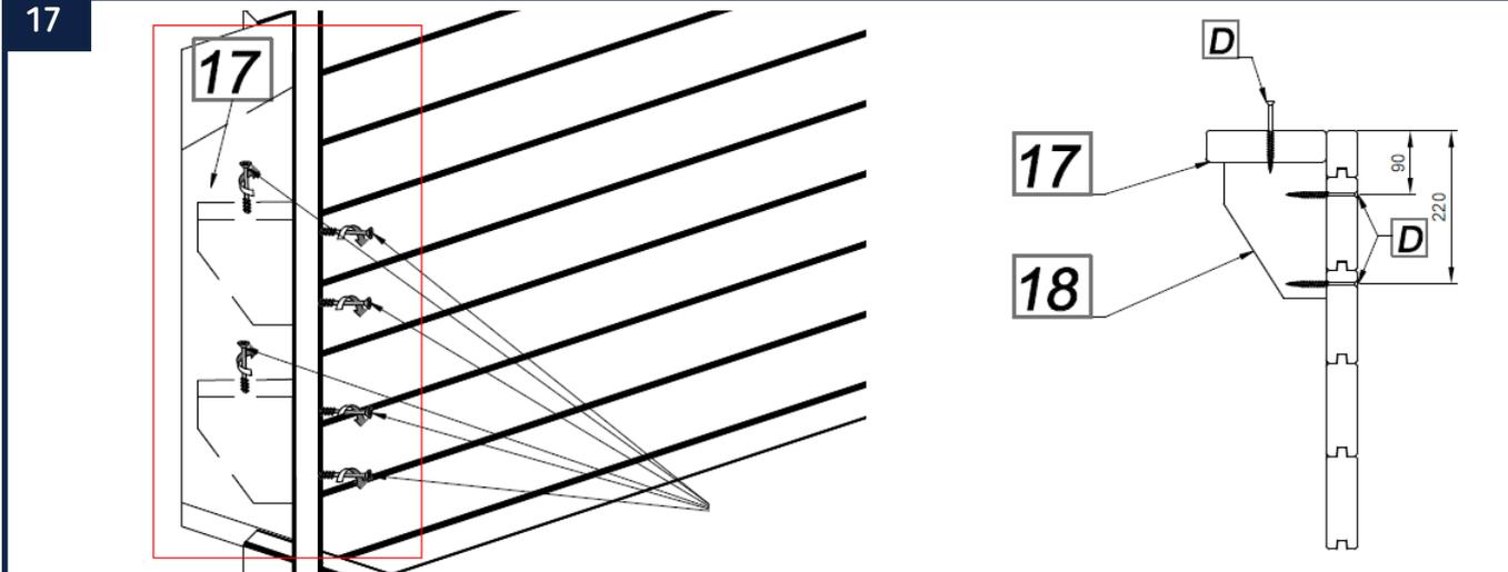
Fixez ensuite les derniers supports de margelles (18) à l'aide de 2 vis 5 x 100 mm (D) en suivant précisément les indications présentées ci-dessus. Une fois cette action réalisée, fixez à l'aide de 2 vis 5 x 100 mm (D) le renfort d'escalier (17) aux supports de margelle (18) comme indiqué ci-dessus. Pour vous faciliter la tâche, utilisez une visseuse équipée d'un embout PZ2.
