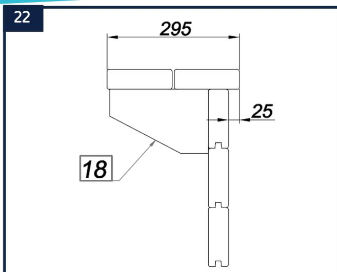
Positionnez correctement les margelles de votre piscine en respectant les côtes indiquées sur le schéma ci-dessus. Veillez à laisser un espace de 5 mm entre les margelles intérieures et extérieures.
